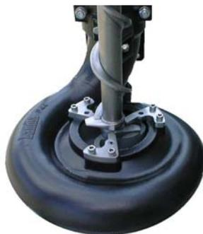
Pumpegehäuse mit aus-geweitetem Messersystem.
